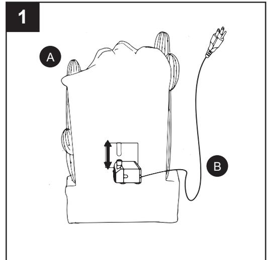
2. Asegúrese de que el cable de alimentación de la bomba (B) esté fuera del artículo y luego llene la base (A) con agua limpia. Nota: El nivel máximo de agua debe estar a aproximadamente 3,04 cm por debajo del borde superior de la base (A).
