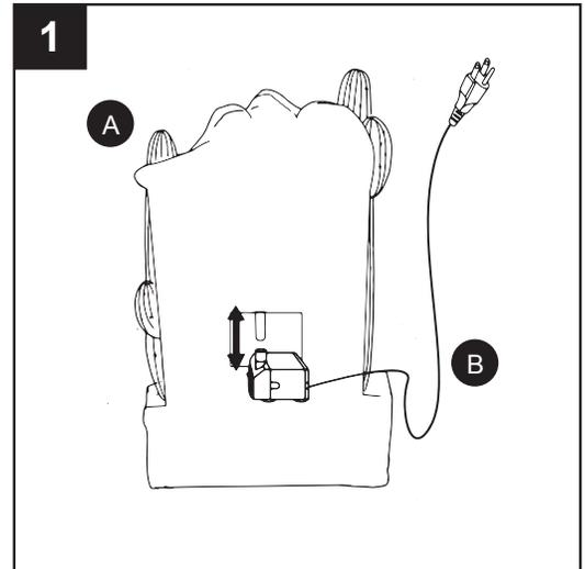
2. Assurez-vous que le cordon d'alimentation de la pompe (B) sort de l'article, et remplissez la base (A) d'eau. Remarque : Le niveau d'eau maximal devrait se situer à environ 3,04 cm sous le bord de la base (A).
