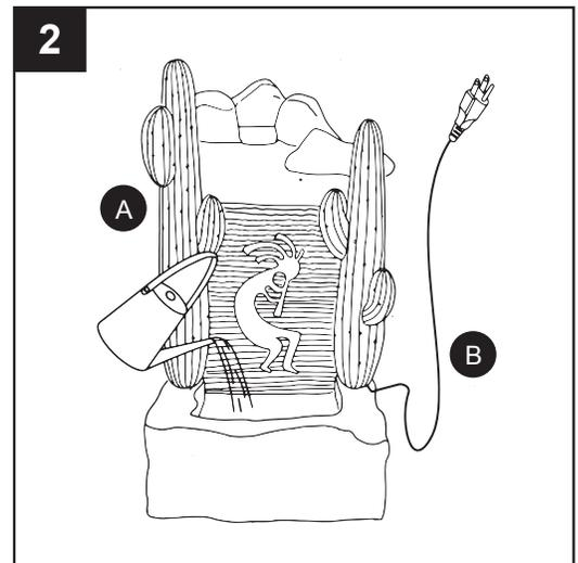
3. Pour finir, branchez la fiche de la pompe (B) sur une prise munie d'un disjoncteur différentiel. **AVERTISSEMENT** : Débranchez toujours la pompe (B) avant de mettre vos mains dans l'eau. Débranchez toujours la pompe (B) avant de remplir la base (A) d'eau.
