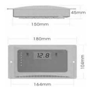
Profondeur: 45 mm (1,77"); largeur: 180 mm (7,1"); longueur: 104 mm (4,1")
