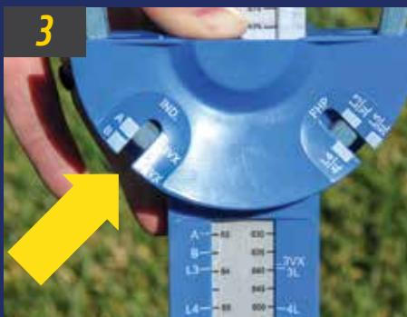
Determine el ancho de la correa; para ello, use las marcas que se encuentran en el costado de la guía inferior. (En este ejemplo, se muestra una correa "A").
