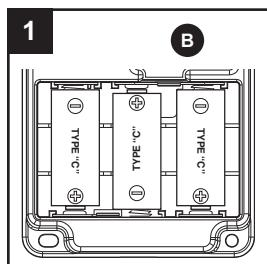
Si la campanilla no está conectada a los cables del transformador, instale 3 baterías alcalinas "C" (no se incluyen) en la base de la campanilla (B). Asegúrese de que las baterías estén orientadas correctamente.
