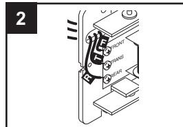
"T" – Cable del transformador
