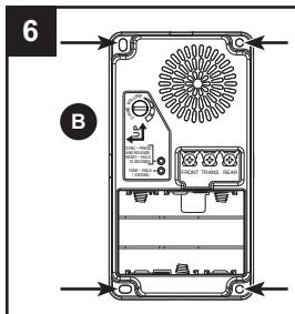
Raccordez les fils du carillon à la base de carillon (B). Raccordez le fil « F » à la borne qui porte l'indication « FRONT » (avant). Raccordez le fil « T » à la borne qui porte l'indication « TRANS ». Raccordez le fil « R » à la borne qui porte l'indication « REAR » (arrière). *Remarque : Certaines installations n'incluent pas de bouton-poussoir de porte arrière.*
