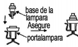
Fig. 3 Reemplace con la lámpara de repuesto
