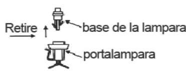
Fig. 2 Retire la lámpara quemada
