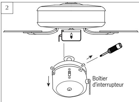
Desserrez les vis d'arrêt du boîtier d'interrupteur. Gardez les vis pour plus tard.
