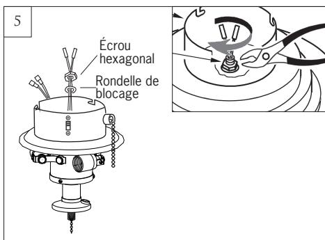
Passez les fils électriques du système d'éclairage dans la rondelle de blocage et l'écrou hexagonal, puis serrez de façon sécuritaire avec la tige du système d'éclairage.
