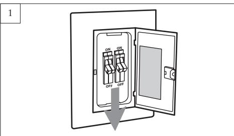
Avant de procéder à l'installation du ventilateur, coupez le courant au niveau du panneau d'entrée d'électricité et verrouillez le dispositif de sectionnement pour éviter que le courant ne soit branché accidentellement. Si vous ne parvenez pas à verrouiller le dispositif de sectionnement, placez sur le panneau d'entrée d'électricité une pancarte ou une étiquette de mise en garde bien visible.
