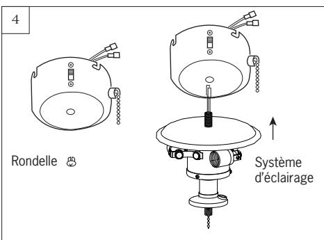
Enlevez la rondelle du dessous du boîtier d'interrupteur. Passez les fils électriques du système d'éclairage dans le trou central du boîtier d'interrupteur, puis fixez le boîtier d'interrupteur sur le système d'éclairage en le tournant dans le sens des aiguilles d'une montre jusqu'à ce qu'il soit bien serré.
