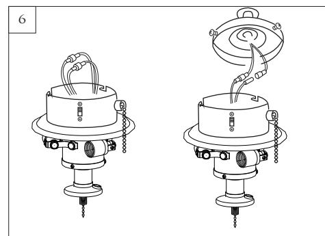
Branchez le fil blanc du système d'éclairage avec le fil blanc du boîtier d'interrupteur (ou ventilateur), puis branchez le fil noir du système d'éclairage avec le fil noir (ou bleu) du boîtier d'interrupteur (ou ventilateur).
