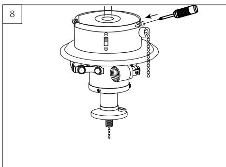
Installez le kit d'éclairage (boîtier d'interrupteur) sur le ventilateur à l'aide des vis d'arrêt enlevées à l'étape 2.
