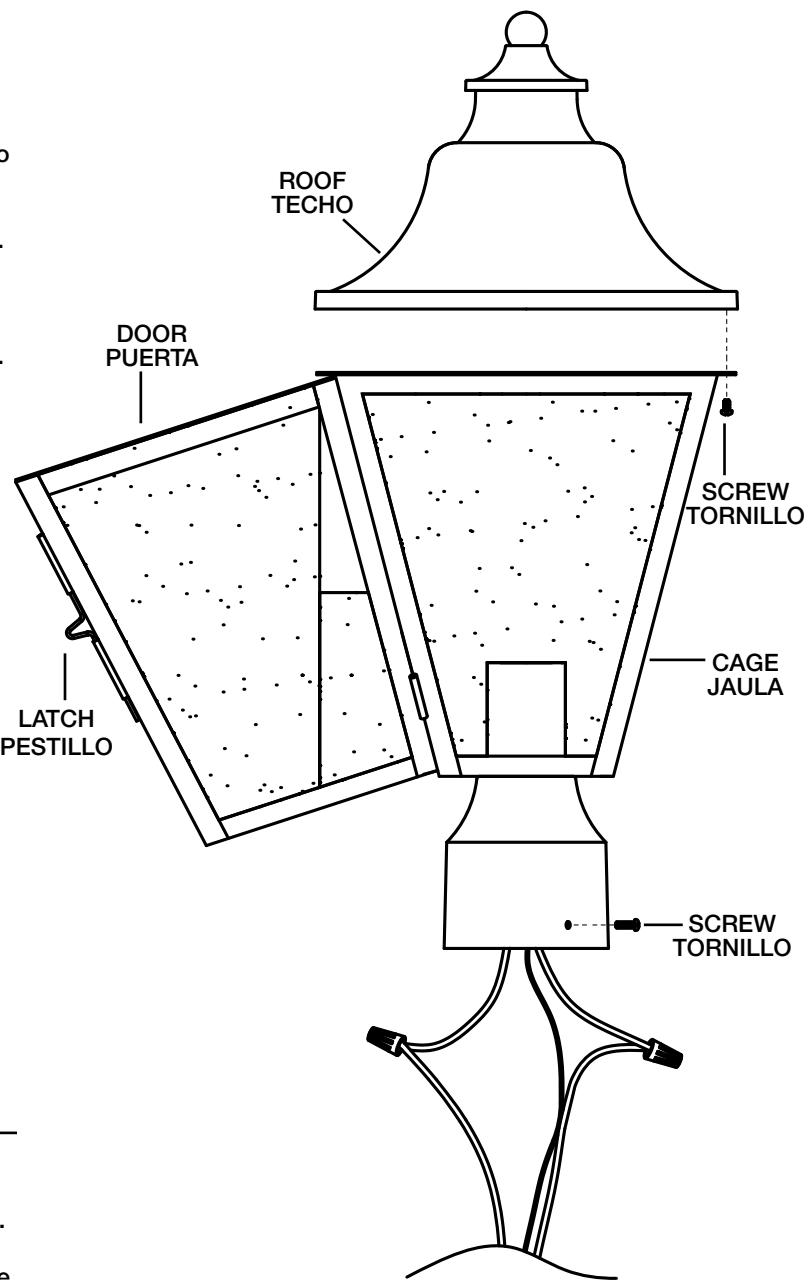
7) Deslice el artefacto sobre la columna, fíjelo en su lugar usando los tornillos que se proporcionan. Los tornillos deben entrar perfectamente en los orificios que previamente perforó en la columna.
