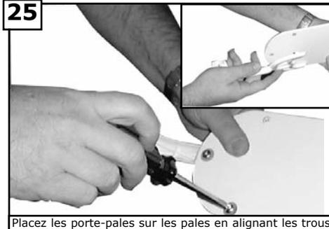
Placez les porte-pales sur les pales en alignant les trous de chaque porte-pale avec les trous de chaque pale. Assurez-vous que le côté de la pale que vous sélectionnez est tourné vers le bas. Installez 3 vis et les rondelles en fibres à l'arrière de la pale comme indiqué. Serrez les vis à fond. Répétez ce processus 4 fois jusqu'à ce que vous ayez assemblé toutes les pales.
