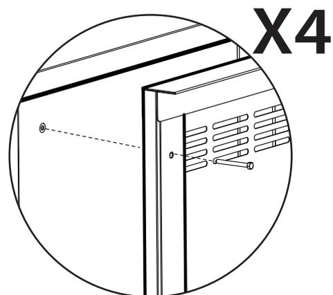
\* Boulons vont enfiler dans des écrous d'insertion sur les côtés de l'armoire .
