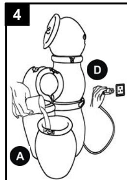
Remplissez doucement la base (A) d'eau de façon à ce que la pompe (D) soit entièrement immergée. Branchez la pompe (D) sur une prise de courant. Pour ajuster le débit de l'eau, utilisez le petit levier situé sur la pompe (D). Inclinez le levier vers le signe « + » afin d'augmenter le débit et vers le signe « - » pour le diminuer.
