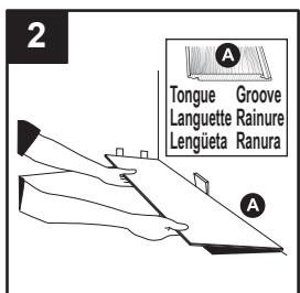
Seleccione una plancha (A) para comenzar la instalación de la primera fila. **Nota:** elija una de las planchas más largas disponibles. Comenzando desde la IZQUIERDA con la lengüeta de la plancha (A) apuntando hacia la pared, coloque cuidadosamente la plancha (A). Use cuñas o retazos de 12,7 mm (no se incluyen) a lo largo de la pared para mantener la plancha (A) en su lugar al mismo tiempo que deja un espacio de expansión de 12,7 mm.
