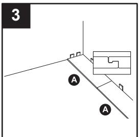
Alinee la siguiente plancha (A) sobre el extremo de la primera plancha (A) de manera que la unión en la primera plancha (A) quede apretada cuando la segunda plancha (A) esté plana.
