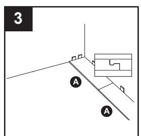
Alinee la siguiente plancha (A) sobre el extremo de la primera plancha (A) de manera que la unión en la primera plancha (A) quede apretada cuando la segunda plancha (A) esté plana. **Nota:** Pueden ser necesarios pequeños ajustes de las planchas (A) para asegurar un ajuste firme.
