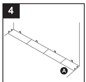
Continúe de esta manera hasta completar la primera fila. Corte la última plancha (A) al largo adecuado, dejando una zona de expansión de 12,7 mm. Coloque cuñas según sea necesario.
