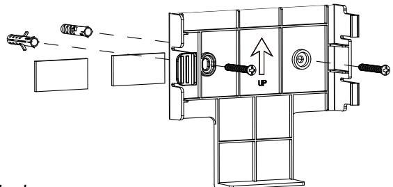
**Recommandation :** Suivez les mesures proposées ci-dessous pour déterminer le meilleur emplacement pour le support. Placez le support afin qu'il n'y ait pas plus de 6 po entre le côté gauche du support et le robinet. Laissez une distance d'au moins 2 po entre le côté le sommet du support et le comptoir. Idéalement, cet emplacement permet de laisser au moins 8 po sous le support. À l'aide d'un ruban double face, fixez le support au mur.
