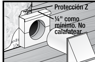
Ilustración 13 Penetración de bloque
