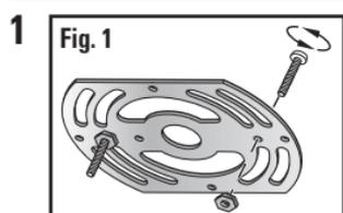
1 Vissez à fond les vis de mécanique longues (incluses) dans les trous filetés sur le support de montage (Fig. 1). Si votre support de montage comporte plus de deux trous filetés, mesurez la distance d'un centre à l'autre des trous pour vous assurer qu'elle correspond aux ouvertures des trous du panneau de fixation de votre luminaire. Vissez les écrous hexagonaux autour des vis de mécanique longues jusqu'à ce qu'ils soient bien serrés contre le support de montage.
