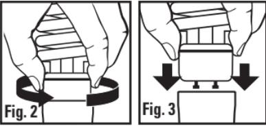
Saisissez l'ampoule de remplacement de la même manière. Insérez l'ampoule de remplacement dans la douille et faites tourner l'ampoule dans le sens des aiguilles d'une montre jusqu'à ce qu'elle repose fermement à sa place (**Fig. 2 et Fig. 3**). Ne forcez pas l'ampoule dans la douille et ne serrez pas trop fort. Remettez le luminaire sous tension.
