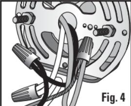
**Fig. 4** Conecte los hilos de alimentación de la caja eléctrica a los hilos terminales del aplique de luz, utilizando las tuercas para alambre de tamaño suministradas en su juego de tornillería de instalación, de acuerdo con la ilustración (**Fig. 4**). El hilo negro del aplique de luz va al hilo de alimentación negro y el hilo blanco del aplique de luz va al hilo de alimentación blanco.
