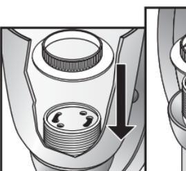
**Fig. 7** El accesorio para iluminación puede estar empacado con el anillo de bloqueo del difusor ya instalado en su sitio. Si éste es el caso, será necesario retirar el anillo de fijación del difusor antes de instalar el difusor (**Fig. 7**). Desenrosque el anillo de fijación del difusor girándolo en sentido contrario al de las agujas del reloj. Póngalo a un lado. Mientras sujeta el difusor de vidrio, asegure el difusor
