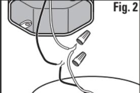
Quite la lámpara vieja. Hágase un boceto de cómo está cableada la lámpara (indique en el boceto el color de los cables) o marque los cables mismos con cinta adhesiva de pintor y un lápiz para que recuerde cómo conectar los cables a su nueva lámpara (**Fig. 2**). Si hay varios cables involucrados o si el cableado parece más complicado y quizás incluye un cable rojo, anote las conexiones antes de desconectarlas.
