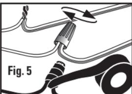
**Fig. 5** Apriete apropiadamente las tuercas para alambre, para evitar que los cables se aflojen (**Fig. 5**). Pegue las tuercas al cable utilizando cinta aislante. Empuje cuidadosamente todo el exceso de cable de vuelta al interior de la caja eléctrica.
