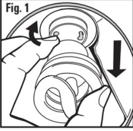
Retirez l'ampoule à remplacer en la saisissant fermement par son culot en plastique et faites tourner fermement l'ampoule dans le sens contraire des aiguilles d'une montre jusqu'à ce qu'elle ne soit plus assujettie et qu'elle s'aligne avec la grande extrémité des ouvertures (**Fig. 1**). Tirez tout droit vers le haut. Faites
