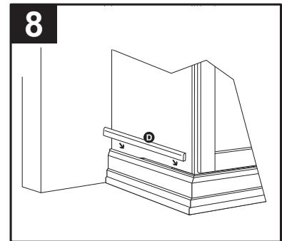
S'il y a un écart entre le haut de la partie recourbée du panneau d'extrémité et la moulure en raison du nivellement, effectuez un test d'insertion d'une moulure contre-profilée (D) entre la façade avant de l'armoire et le mur. Coupez l'excédent au besoin. Fixez au panneau d'extrémité à l'aide de clous de finition (non inclus).
