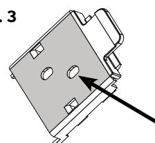
Ce côté doit être orienté vers la surface de montage.
