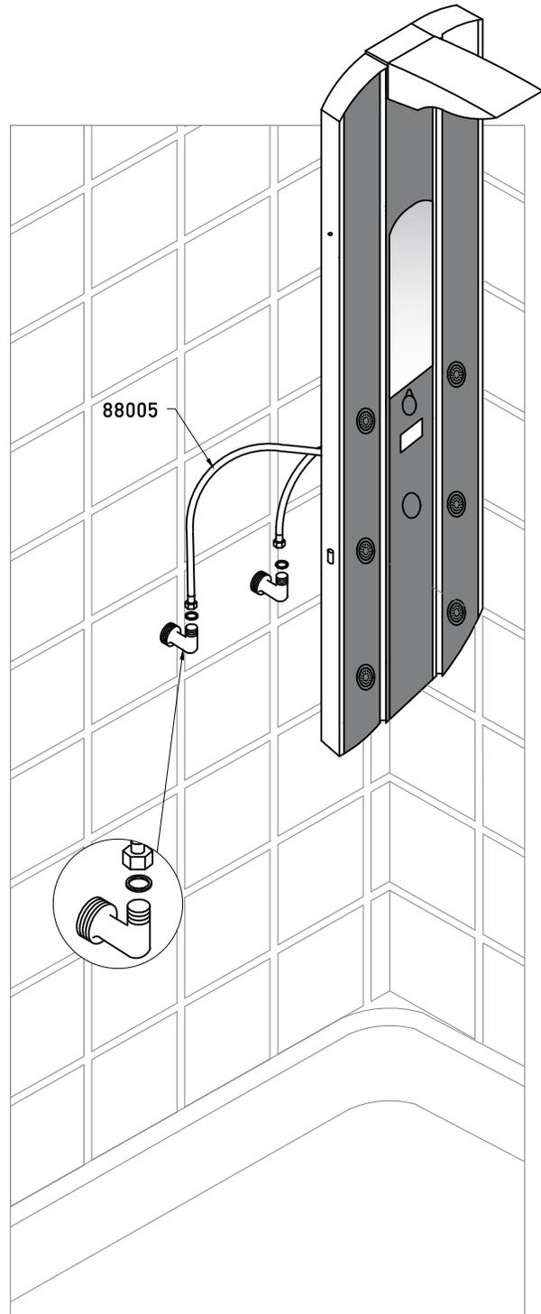
Ahórrese tiempo y desconcierto: si al girar la llave del control de volumen/temperatura sale agua caliente y fría pero el agua no se mezcla, las mangueras se han conectado a las entradas incorrectas. Sírvase desconectar las mangueras, conectarlas de nuevo a las entradas correctas y probar la unidad.
