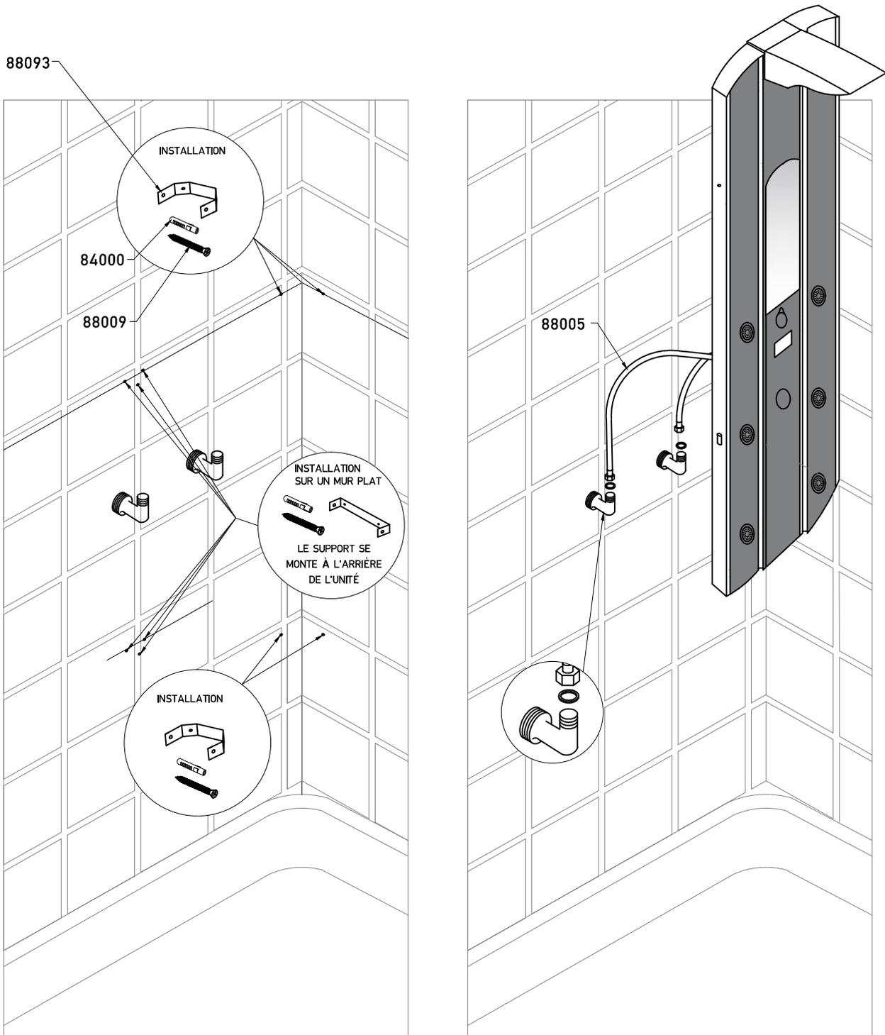
Évitez la perte de temps et les désagréments : si la poignée du volume et de la température donne de l'eau chaude et de l'eau froide sans qu'il y ait mélange, les tuyaux sont raccordés aux mauvaises arrivées d'eau. Débranchez-les et rebranchez-les sur les bonnes arrivées, puis tester l'unité.
