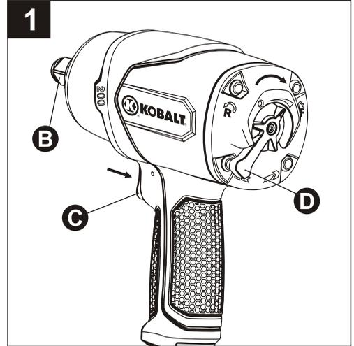
2. Cómo retirar/soltar sujetadores roscados. Presione el interruptor (D) hacia atrás y haga que la flecha en el interruptor (D) apunte al punto de la carcasa posterior, como se muestra. Presione el gatillo (C). El yunque de la herramienta (B) funciona en dirección contraria a las manecillas del reloj. (Consulte la Figura 2)
