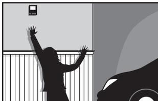
Le bouton-poussoir monté au mur doit être hors de portée des enfants à au moins 1,5 m (5 pi) de la surface d'appui la plus proche et à l'écart de toutes les pièces mobiles. Monter et utiliser le bouton à un endroit où vous pouvez voir clairement la porte de garage se fermer.
