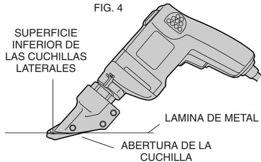
Para retirar las cuchillas de la cabeza, saque los 3 tornillos de la carcasa de la cizalla. Sea cuidadoso para no perder el buje espaciador trasero cuando quite el tornillo de enmedio. Saque la cuchilla central de la carcasa aplicándole unos golpecillos hacia atrás. La cuchilla y el espaciador laterales saldrán ahora de la carcasa.
