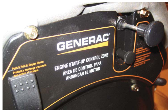
Figura 19 - Posición Full Choke
