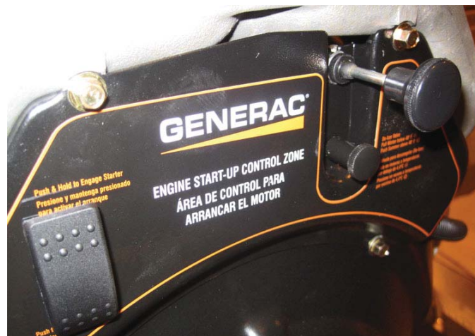
Schéma 19 - Position d'étrangleur plein
