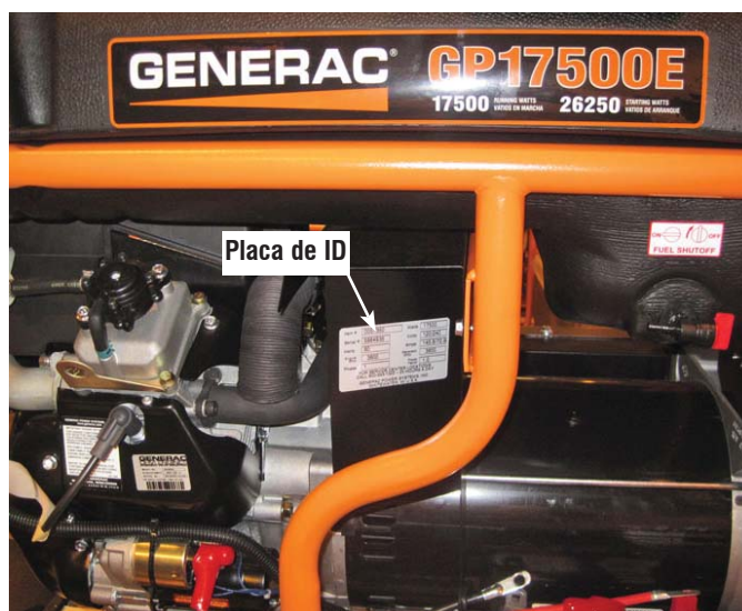
Figura 1 - Paca de ID del generador
