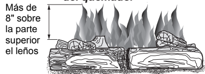
Figura 33 - Patrón incorrecto de la llama del quemador
