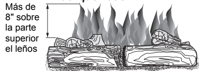
Figura 33 - Patrón incorrecto de la llama del quemador
