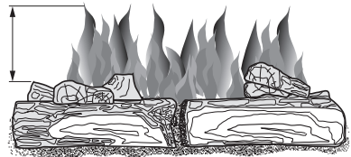
Figura 21 - Patrón incorrecto de la llama del quemador
