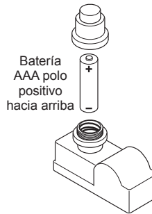
Figura 15 - Instalación de la batería en ignitor
