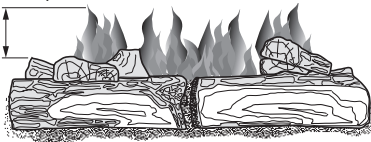
Figura 20 - Patrón correcto de la llama del quemador
