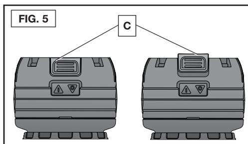
Pour mettre l'outil en marche, poussez l'interrupteur marche/arrêt (C) vers le haut. Pour arrêter l'outil, repoussez l'interrupteur dans le boîtier du moteur. Reportez-vous en figure 5.
