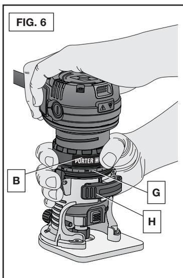
**NOTA:** Cada marca en la escala ajustable representa un cambio de profundidad de 1/64" o 0.015" (0.4 mm) y una vuelta completa (360°) del anillo cambia la profundidad en 0.5" (12.7 mm).
