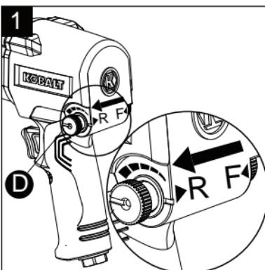
2. Para operar la herramienta en la dirección reversa, presione el interruptor de ajuste de torsión (D) hacia la derecha (consulte la Figura 2).
