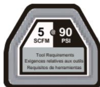
**IMPORTANTE:** para funcionar correctamente, esta herramienta necesita un flujo de aire de al menos 5 pies cúbicos estándar por minuto (SCFM, por sus siglas en inglés) a 90 libras por pulgada cuadrada (PSI por sus siglas en inglés) en la herramienta. El largo de la manguera de aire podría afectar la cantidad de presión de aire que recibe realmente la herramienta. Es posible que deba ajustar la presión de aire más alta en el regulador de aire para lograr la presión de trabajo de 90 PSI.
