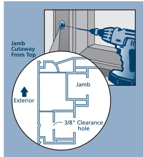
**IF INSTALLING A FLUSH FIN WINDOW**
