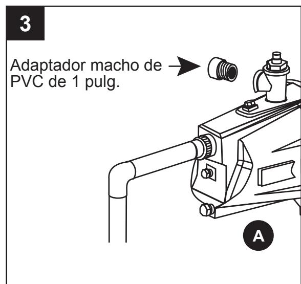
4. Continúe con los adaptadores y el tubo de 1 pulg del tanque de presión. Se recomienda usar una unión de 1 pulg. opcional (no se incluye) para facilitar la conexión y la desconexión.
