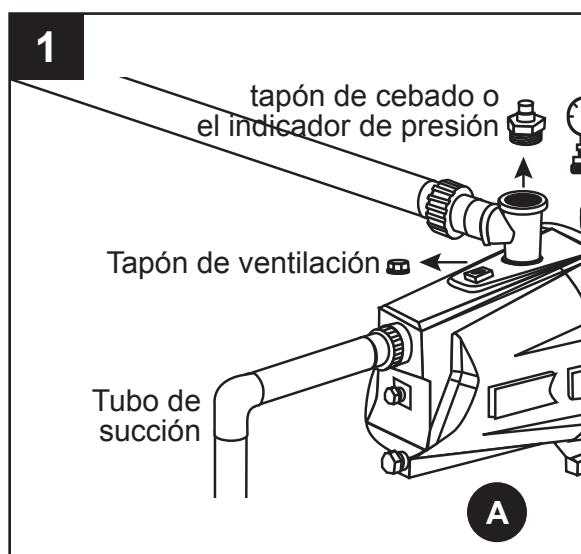
2. Llene lentamente el conector de descarga con agua hasta que se desborde de la abertura del tapón de ventilación. Vuelva a colocar el tapón de ventilación sin apretarlo.
