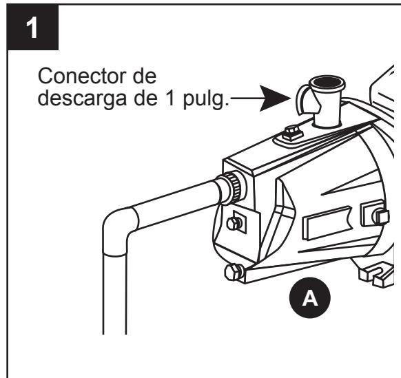
2. Instale un conector galvanizado de 1 pulg. MPT x 1/4 pulg. FPT y un indicador de presión (opcional) (no se incluyen) o un tapón para tubería (no se incluye). No apriete ahora, ya que después tendrá que cavar la bomba (A) en este lugar.
