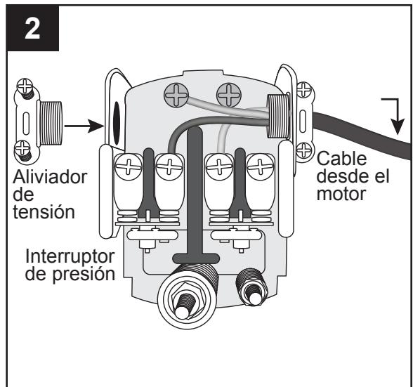
3. Pase el cable eléctrico (no se incluye) del suministro de electricidad a través del aliviador de tensión y apriete ambos tornillos en el aliviador de tensión. No aplaste el cable.
