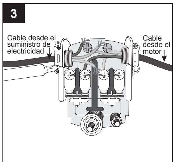
4. Conecte los dos cables del suministro de electricidad a los dos terminales exteriores del interruptor de presión.
