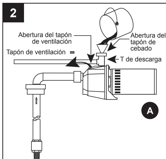
3. Asegúrese de que la tubería de succión se llene completamente al realizar el cebado. Dependiendo de la longitud de la tubería de succión, podrían necesitarse varios litros para llenar completamente el sistema.
