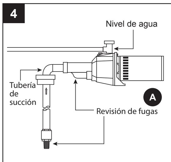
5. Una vez que la bomba (A) esté llena, cubra el indicador de presión o el tapón del conector de descarga y las roscas del tapón de ventilación con cinta para roscas y enrósquelos en la bomba (A). Apriete con una llave de tuercas.
