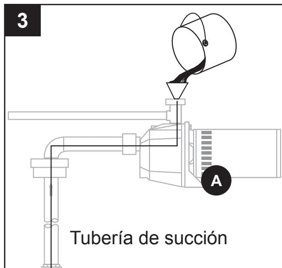
4. Asegúrese de que el nivel de agua en la cavidad de la bomba (A) sea constante. Si el nivel del agua baja, podría haber una fuga en la válvula de pie. Revise la válvula o el tubo de succión.
