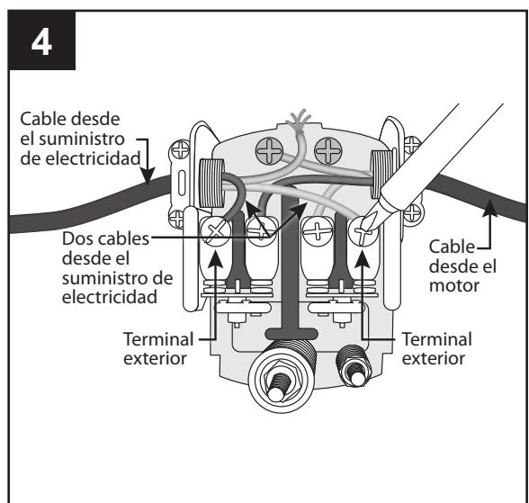
5. Conecte el conductor de puesta a tierra verde del suministro de electricidad al tornillo de puesta a tierra verde que queda en el interruptor de presión y vuelva a colocar la cubierta del interruptor de presión.
