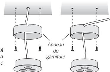
Passer le câble d'alimentation à travers la surface de l'armoire ou l'encoche de l'anneau de garniture
