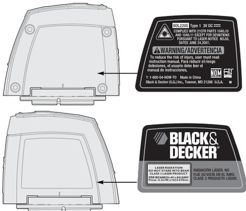
Avoid exposure-Laser radiation emitted from this aperture. Éviter toute exposition au rayonnement laser émis par cette ouverture. Evite la exposición - Por este orificio se emite la radiación láser.
