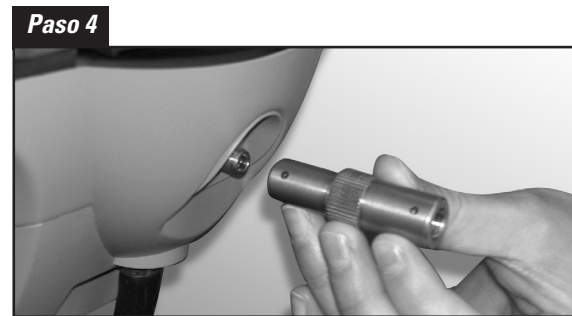
Primero entornille a mano el adaptador Quick Clear en la válvula.
