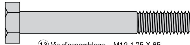
⑬ Vis d'assemblage – M12-1,75 X 85
