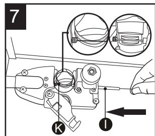
Continúe pasando el alambre de soldadura a través y dentro de la entrada de alimentación del alambre (L).
