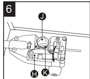
Insérez le fil de soudage dans le tube d'alimentation (I) et dans la rainure supérieure du dévidoir (K).
