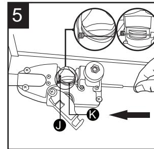
Avant d'insérer le fil de soudage dans l'ensemble d'alimentation en fil, veillez à tenir fermement l'extrémité du fil tout en exerçant une pression constante sur le fil pendant le processus d'installation. Si vous relâchez le fil, ce dernier sortira de l'ensemble d'alimentation du fil et s'emmêlera, rendant ainsi le fil inutilisable.
