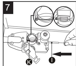
Poussez sur le fil de soudage jusqu'à ce qu'il s'insère dans l'orifice d'entrée du fil de soudage (L).
