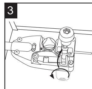
Après avoir soulevé le bras de tension, ouvrez le bras pivotant (H) de façon à pouvoir insérer le fil de soudage dans l'ensemble d'alimentation en fil (F).
