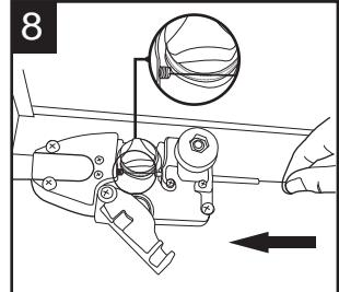
Après avoir inséré le fil de soudage dans l'orifice d'entrée (L), fermez le bras pivotant (H) et abaissez le bras de tension. Serrez ensuite légèrement le bouton de réglage de la tension (G).
