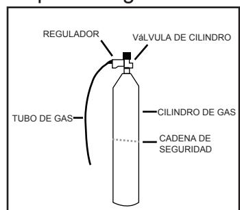
Para fijar el cilindro o la botella externos de forma adecuada, se debe usar una cadena de seguridad para fijar la botella o el cilindro a una pared o a otro soporte fijo o estable. Una vez que la botella o el cilindro estén fijados de forma correcta, verifique que la cadena de seguridad esté asegurada, de manera que evite que la botella o el cilindro se resbalen o caigan. Aísle la base del cilindro del suelo del área de trabajo.
