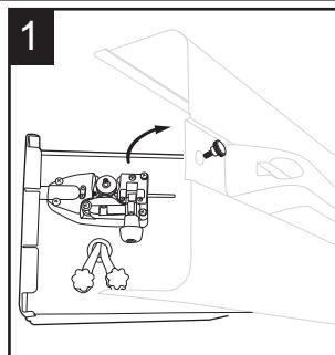
Dévissez l'écrou de serrage (O) et retirez le capuchon et le ressort de la bobine. Installez une bobine de fil de soudage de 0,91 kg (non incluse) sur l'axe de la bobine de fil (N). Fixez la bobine de fil de soudage sur l'axe (N) à l'aide du ressort et du capuchon. Serrez l'écrou de serrage (O) à la main jusqu'à ce que vous sentiez une légère résistance en tournant la bobine.
