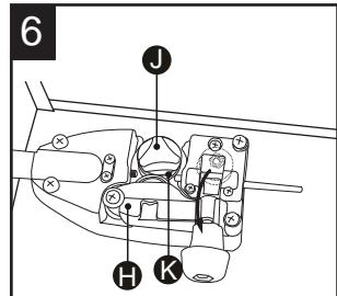
Pase el alambre de soldadura a través del tubo de alimentación (I) y por la ranura superior de la rueda de alimentación (K).
