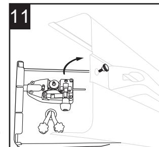
Una vez que el alambre de soldadura esté asegurado correctamente, suelte la tuerca de mariposa para retirar el carrete del alambre de soldadura del eje del carrete. Suelte la perilla de ajuste de tensión girándola en dirección contraria a las manecillas del reloj y luego levántela.
