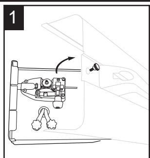
Desatornille la tuerca de mariposa (O) y retire la parte superior de la perilla del carrete y el resorte. Instale un carrete de alambre de soldadura de 0,91 kg (no se incluye) en el eje del carrete del alambre (N). Asegure el carrete del alambre de soldadura al eje del carrete del alambre (N) usando el resorte que está debajo y la perilla que se encuentra en la parte superior. Apriete la tuerca de mariposa (O) con la mano hasta que sienta una ligera resistencia al girar el carrete.
