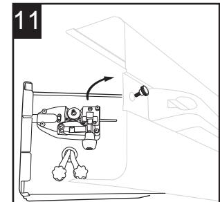
Après avoir fixé correctement le fil de soudage, desserrez l'écrou de serrage pour retirer la bobine de l'axe. Desserrez le bouton de réglage de la tension en le tournant dans le sens contraire des aiguilles d'une montre, puis soulevez le bras de réglage de la tension.
