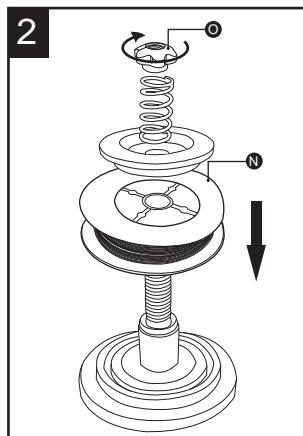
Desserrez le bouton de réglage de la tension en le tournant dans le sens contraire des aiguilles d'une montre, puis soulevez le bras de réglage de la tension.
