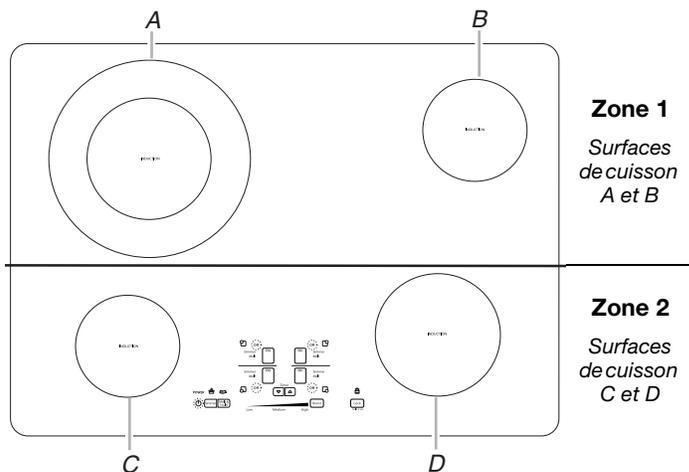
Si l'on tente d'utiliser la fonction d'optimisation du rendement sur plus d'une surface de cuisson dans une même zone, "P" clignote brièvement sur l'affichage et la première surface de cuisson sélectionnée pour la fonction d'optimisation du rendement est automatiquement ramenée au réglage de puissance le plus élevé possible. La dernière surface de cuisson sélectionnée sera réglée à Optimisation du rendement.
