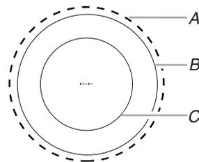
A. Dépassement maximal de 1/2" (1,3 cm)
