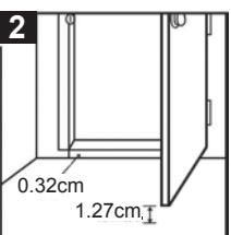
Coupez le montant à 0,32 cm du sous-plancher. Coupez la porte à 1,27 cm du sous-plancher
