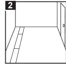
Avant de retirer la pellicule protectrice des planches (A), placez une rangée de planches d'essai le long de la ligne tracée à une distance du mur égale à la largeur des planches (A). Corrigez la ligne si elle n'est pas droite. Retirez ensuite la rangée de planches (A) d'essai.
