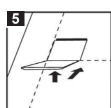
Retire el papel de cobertura de la placa (A) para dejar el adhesivo expuesto. Ponga la primera placa (A) en la esquina de la primera línea y de la línea central. Precaución: Deseche el papel de cobertura inmediatamente después de retirarlo de todas las placas (A).
