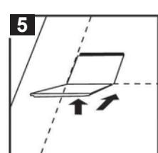
Ubique la segunda placa (A) con un ajuste ceñido con la primera placa (A), comience a alinear con cuidado las esquinas de cada placa (A) para mantener una línea recta.
