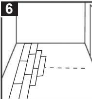
6. Continue to set full planks (A) in a pyramid layout. Continuez à placer les planches (A) intégrales de façon à former un triangle.
