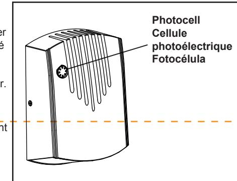
Note: If the fixture is installed in a shaded or covered area where there is little direct sunlight, the light may come on during the day./ Remarque : Si le luminaire est installé dans un endroit ombragé ou couvert recevant très peu de rayons de soleil directs, il est possible qu'il s'allume le jour./ Nota: si la lámpara está instalada en un área con sombra o cubierta donde llega poca luz solar directa, puede que la luz se encienda durante el día.
