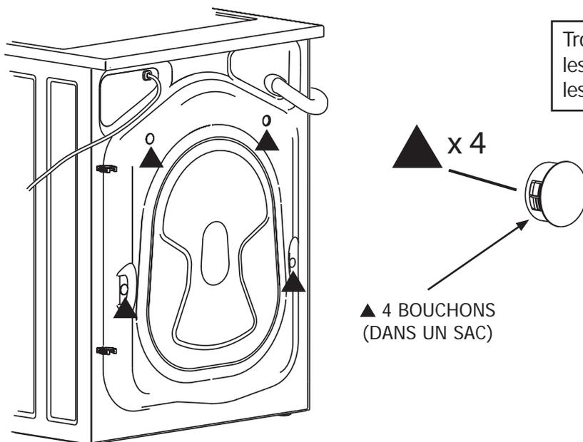
Trouvez les 4 bouchons du petit sac fourni avec les guides de votre laveuse. Insérez-les dans les trous du panneau arrière de la laveuse.
