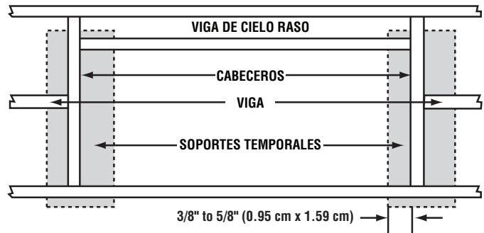
FIGURA 4 - ABERTURA ENMARcada CON LISTONES DE SOPORTE TEMPORAL LISTOS PARA RECIBIR LA ESCALERA
