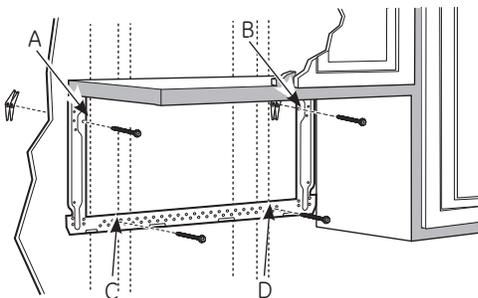
Pegue el plato a la pared usando los tornillos basculantes. Por lo menos un tornillo de madera debe ser usado para pegar el plato al poste de la pared. Las ubicaciones recomendadas sobre la placa de montaje se indican en A, B, C y D.
