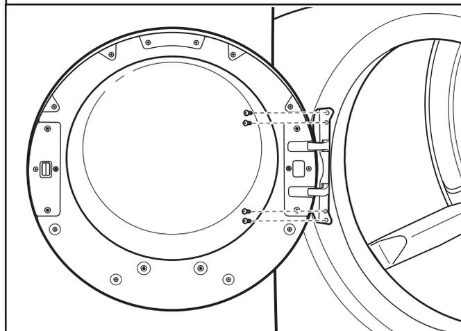
À l'aide d'un tournevis TORX T25®, retirer les 4 vis de la sécheuse. Insérer les onglets sur la charnière dans l'encoche de montage et les faire glisser vers le bas pour engager l'onglet supérieur. Fixer avec les 4 vis TORX T25® précédemment retirées.
