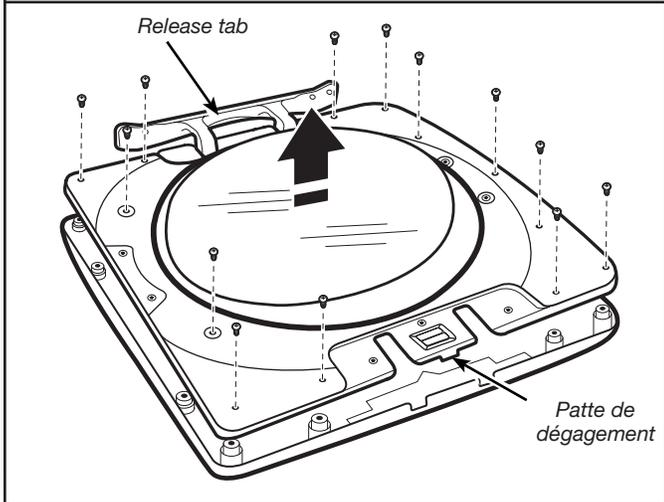
Positionner la porte de façon à ce que l'intérieur de la porte soit orienté vers le haut. À l'aide d'un tournevis Phillips, retirer les 13 vis fixant la porte interne à la porte externe. Soulever la porte interne pour la dégager et la mettre de côté.
