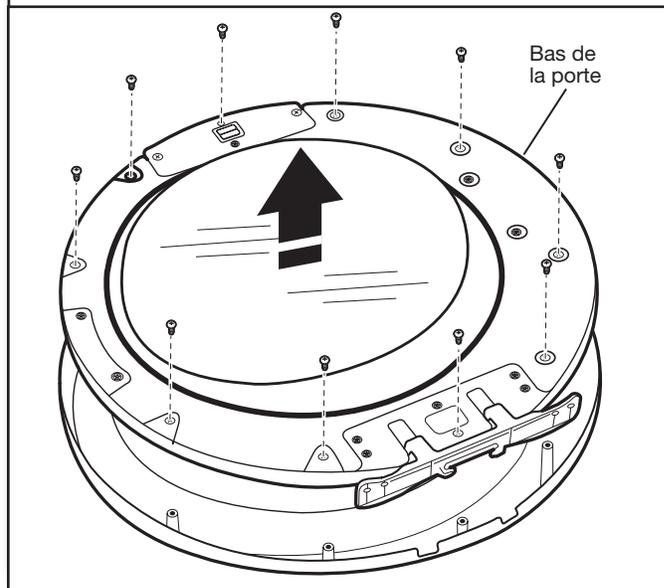
Positionner la porte de façon à ce que l'intérieur de la porte soit orienté vers le haut. Réinstaller les 10 vis fixant la porte interne à la porte externe.
