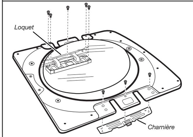
À l'aide d'un tournevis TORX T25®, retirer les 3 vis TORX® fixant la plaque de protection du loquet et la plaque de support du loquet; retirer aussi les 5 vis maintenant la charnière en place.
