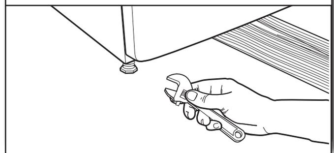
Si la sécheuse n'est pas d'aplomb, la relever à l'aide d'un bloc de bois, utiliser une clé pour ajuster les pieds vers le haut ou vers le bas, et vérifier à nouveau si elle est d'aplomb. Une fois la sécheuse d'aplomb, s'assurer que les quatre pieds sont en contact ferme avec le plancher et que la sécheuse ne tangué pas.
