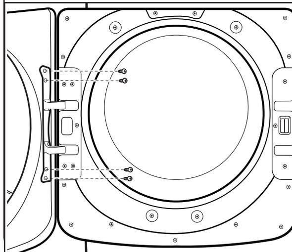
À l'aide d'un tournevis TORX® T25®, retirer les 4 vis fixant la charnière de porte à la sécheuse et soulever la porte pour la retirer. Placer la porte sur une serviette douce ou sur une surface lisse. Conserver ou mettre les 4 vis de côté.
