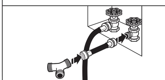
Fixer un tuyau d'arrivée d'eau de 2 pi (0,6 m) au robinet d'eau froide. Visser complètement le raccord à la main pour qu'il soit scellé au robinet. Puis fixer le raccord en "Y" à l'extrémité mâle du tuyau d'arrivée d'eau de 2 pi (0,6 m). Visser complètement le raccord à la main pour qu'il soit scellé au connecteur en "Y".
