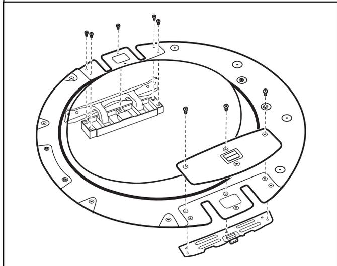
À l'aide d'un tournevis TORX T25®, réinstaller la plaque de protection du loquet, la plaque de support du loquet et la charnière sur les côtés dont elles ont été respectivement retirées.
