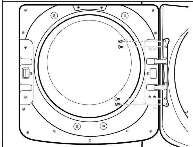
À l'aide d'un tournevis TORX T25®, réinstaller les 4 vis fixant la charnière de la porte à la sécheuse.
