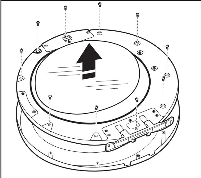
Positionner la porte de façon à ce que l'intérieur de la porte soit orienté vers le haut. À l'aide d'un tournevis Phillips, retirer les 10 vis fixant la porte interne à la porte externe. Soulever la porte interne pour la dégager et la mettre de côté.
