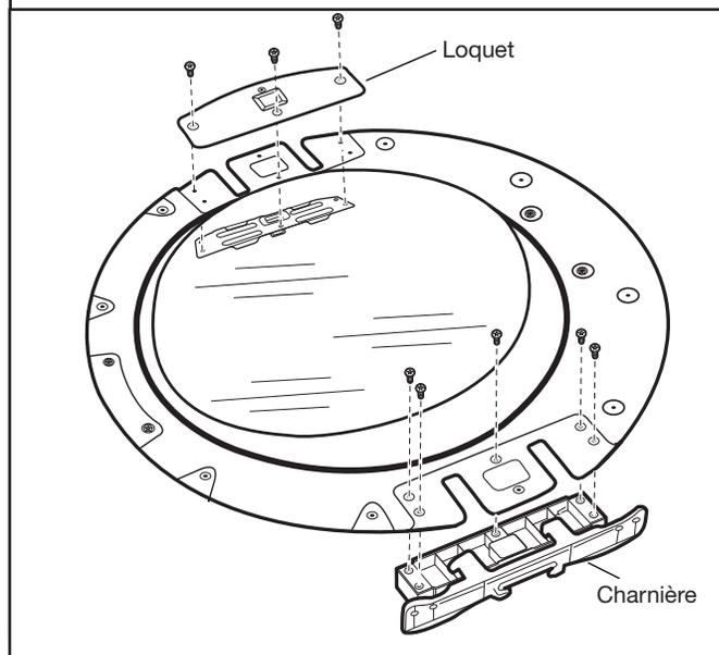
À l'aide d'un tournevis TORX T25®, retirer les 3 vis TORX® fixant la plaque de protection du loquet et la plaque de support du loquet; retirer aussi les 5 vis maintenant la charnière en place.
