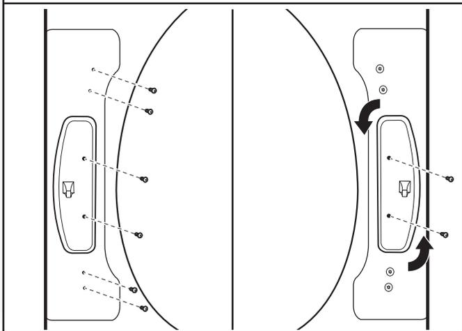
À l'aide d'un tournevis TORX T25®, retirer les 2 vis fixant la gâche de la porte au châssis de la porte de la sécheuse. Retirer les 4 vis au-dessus et en dessous de la gâche de la porte et les mettre de côté pour utilisation ultérieure. Faire pivoter la gâche de 180° et la fixer au côté opposé du châssis de la porte de la sécheuse, tel qu'indiqué.
