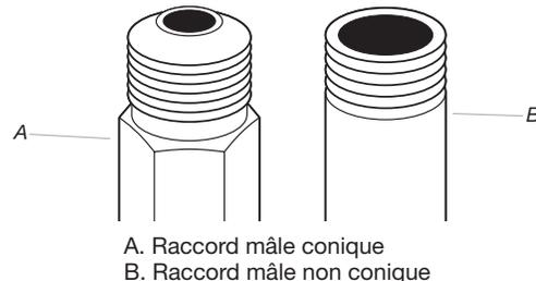
Retirer le capuchon rouge de la canalisation d'arrivée de gaz. À l'aide d'une clé pour serrer, raccorder l'alimentation en gaz à la sècheuse. Utiliser un composé d'étanchéité des tuyauteries sur tous les filetages des raccords mâles non coniques. Si on utilise un conduit métallique souple, veiller à ce qu'il ne soit pas pincé.
