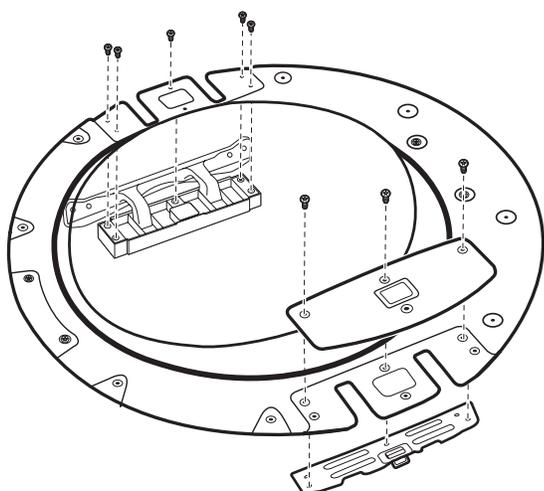
Au moyen d'un tournevis TORX T25®, remonter la plaque de protection du loquet et la plaque de support du loquet avec les 3 vis TORX® ôtées précédemment, ainsi que la charnière avec les 5 vis, du côté opposé à celui duquel elles ont été enlevées.
