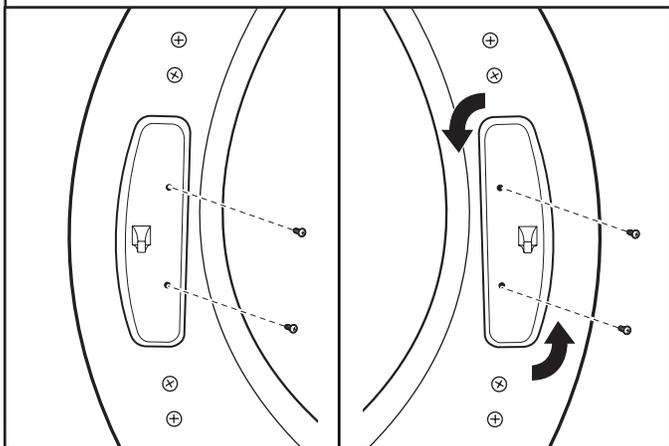
À l'aide d'un tournevis TORX T25®, retirer les 2 vis fixant la gâche de la porte au châssis de la porte de la sécheuse. Faire pivoter la gâche de 180° et la fixer au côté opposé du châssis de la porte de la sécheuse, tel qu'indiqué.
