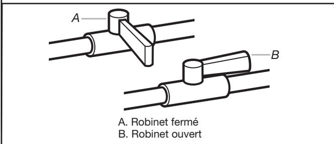
Ouvrir le robinet d'arrêt du conduit d'alimentation; le robinet est ouvert lorsque la poignée est parallèle au conduit. Puis vérifier tous les raccordements en les badigeonnant d'une solution de détection des fuites non corrosive approuvée. L'apparition de bulles indique la présence d'une fuite. Réparer toute fuite éventuelle.
