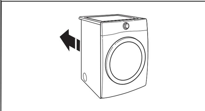
Déplacer la sécheuse à son emplacement final en prenant soin de ne pas écraser ou déformer le conduit d'évacuation ou la canalisation de gaz souple.
