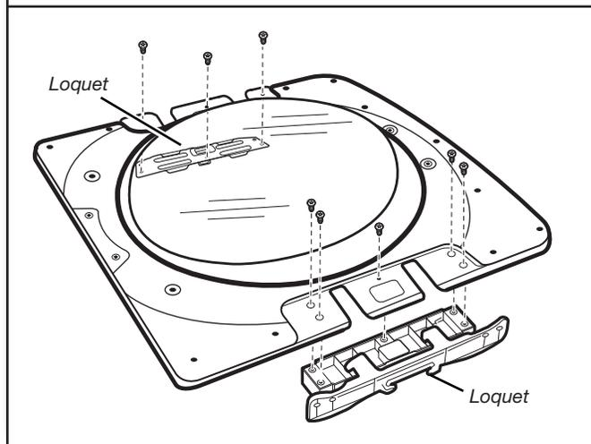
À l'aide d'un tournevis TORX T25®, réinstaller la plaque de protection du loquet, la plaque de support du loquet et la charnière sur les côtés dont elles ont été respectivement retirées.
