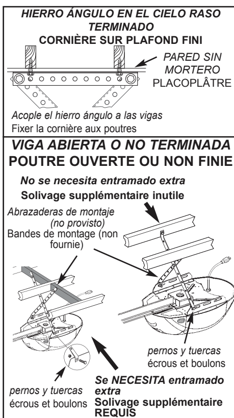
FIG. 2-6 Montaje de la caja de control. Montage de la tête motorisée.
