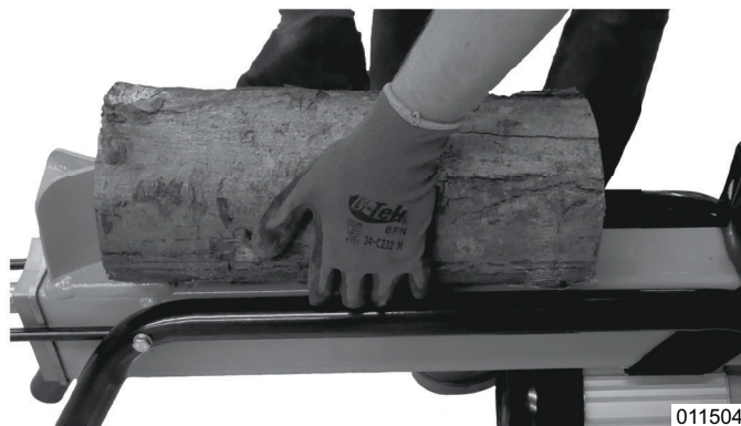
Figure 3-5. Technique adéquate de chargement des bûches
