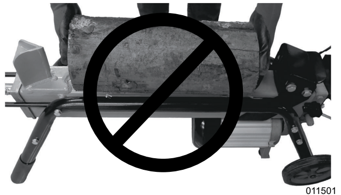
Figura 3-2. No sujetar por los extremos
