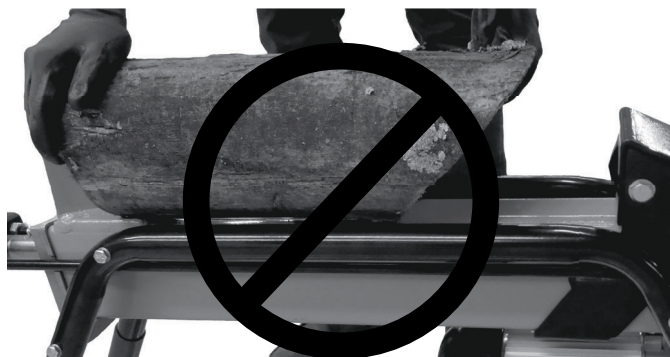
Figure 3-4. N'orientez pas le côté incliné du bois vers le poussoir
