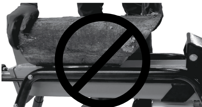
Figura 3-4. No colocar troncos angulados mirando hacia el ariete
