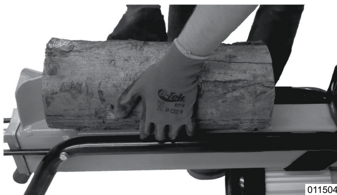
Figura 3-5. Técnica correcta para colocar los troncos
