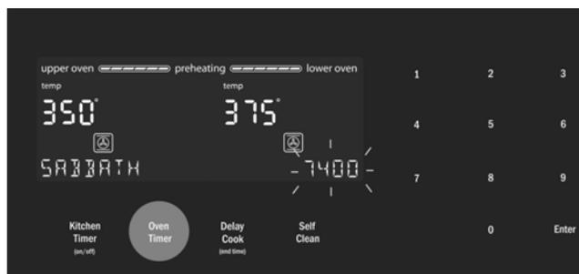
Les fours doubles sur lesquels le mode Shabbat est en cours d'exécution sont indiqués sur l'écran avec la minuterie à compte à rebours du mode Shabbat dans le coin inférieur droit.
