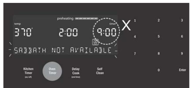
Si aucune minute ne fonctionne, les réglages du mode Shabbat apparaissent à l'écran. La minuterie du mode Shabbat clignote indiquant que la valeur peut être
