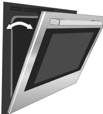
4. Fermer la porte du four jusqu'à ce qu'elle s'accroche sur les leviers d'arrêt des charnières. La porte sera ouverte d'environ 7 po (17,8 cm) sur la partie supérieure. Ceci a pour effet d'éliminer la tension des ressorts exercée sur les charnières ce qui permet de soulever aisément la porte.
