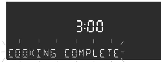
Cet écran reste dans l'affichage jusqu'à ce qu'on l'efface en appuyant sur la touche à effleurement « **Four Effacer/Désactiver** » ou jusqu'à ce que la sonde soit retirée. Ensuite, l'écran repasse en mode Veille.
