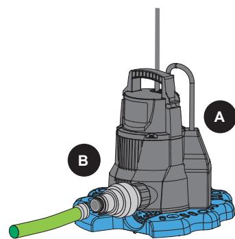
5. Enchufe la bomba en un tomacorriente de GFCI 115 voltios con la debida puesta a tierra. Por seguridad, la bomba siempre debe estar conectada eléctricamente a tierra mediante una puesta a tierra eléctrica adecuada, como una tubería de agua con puesta a tierra, un sistema de canaletas metálicas debidamente conectado a tierra o un sistema de conductor de puesta a tierra.
