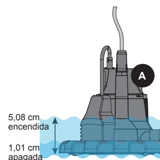
1. Instale el colador a presión (C) alineando la base de la bomba (A) con el colador. Presione suavemente hasta que encaje.
