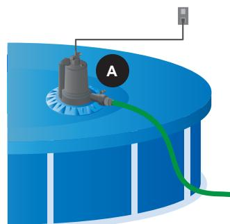
6. La bomba (A) se encenderá cuando el nivel de agua alrededor de la bomba alcance aproximadamente 5,08 cm. El agua debe tener contacto con los sensores de la bomba para que se encienda. Cuando el nivel de agua disminuye a aproximadamente 1,01 cm, la bomba (A) funcionará durante aproximadamente 10 segundos adicionales y luego se apagará.
