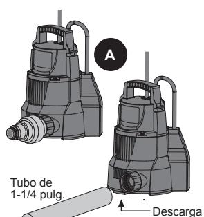
4. Coloque la bomba (A) en posición vertical sobre la cubierta de la piscina, donde se succionará agua. No suspenda la bomba (A) de la manguera de descarga o el cable de alimentación.
