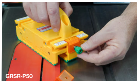
Fig. 2 Installation des Cursors auf dem Grr-ripper
