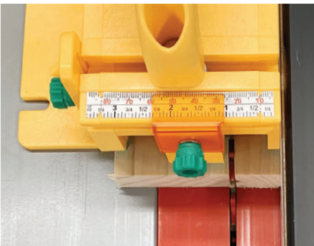
Fig. 4 Curseur SafeRip du Grr-ripper avec échelle
