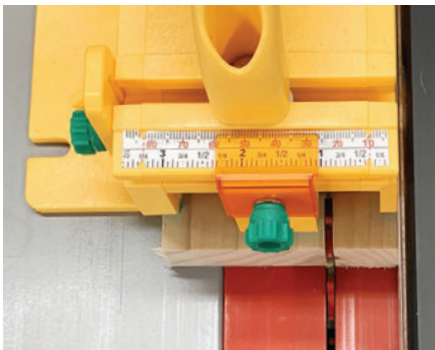
Fig. 4 Cursor SafeRip del Grr-ripper con escala
