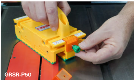
Fig. 2 Instalación del cursor en Grr-ripper
