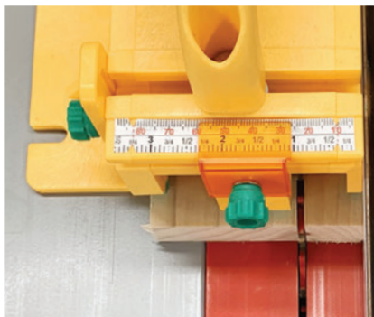
Fig. 4 SafeRip-Cursor des Grr-rippers mit Skala
