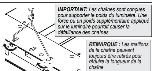
**2A** Déterminez la hauteur à laquelle le luminaire devra être suspendu. Attachez le crochet en « V » (E) à la boucle inférieure de la chaîne (A) en insérant une extrémité du crochet dans la boucle inférieure. Eliminez tous les coude de la chaîne. Suivez la même procédure pour le côté opposé.
