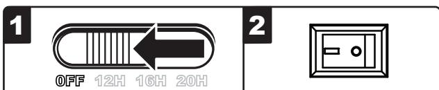
**1** Faites glisser l'interrupteur de la minuterie sur la position ARRÊT/OFF avant d'appuyer sur l'interrupteur basculant.
