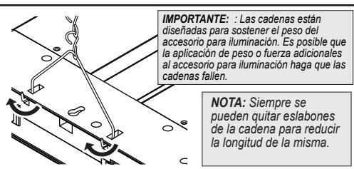
**IMPORTANTE:** Las cadenas están diseñadas para sostener el peso del accesorio para iluminación. Es posible que la aplicación de peso o fuerza adicionales al accesorio para iluminación haga que las cadenas fallen.
