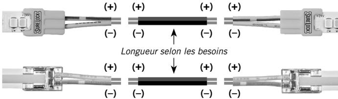
**REMARQUE :** S'assurer que tous les raccordements de fils sont sûrs et scellés. Les options incluent la soudure, le ruban isolant, les connecteurs à sertir, les borniers, les capuchons de connexion, etc.
