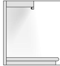
Le montage en série continue d'éclairage en ruban à DEL est obtenu en perçant un trou de 1/2 pouce à travers les rebords latéraux de l'armoire. Lors du montage à l'arrière du rebord du cadre avant, utiliser une scie oscillante multifonction pour effectuer de petites coupes verticales dans les séparateurs afin de créer des fentes permettant au ruban lumineux de passer d'une armoire à l'autre.
