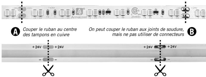
**IMPORTANT:** Toujours utiliser les indicateurs + / - imprimés sur le ruban lumineux pour conserver la même polarité (+ à + et - à -).
