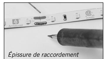
Des raccordements soudés sont requis pour les applications marines et sur les VR compte tenu des mouvements et des vibrations du véhicule.
