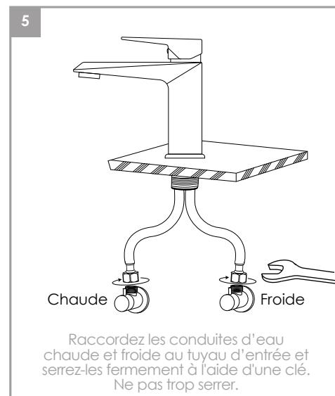
Raccordez les conduites d'eau chaude et froide au tuyau d'entrée et serrez-les fermement à l'aide d'une clé. Ne pas trop serrer.
