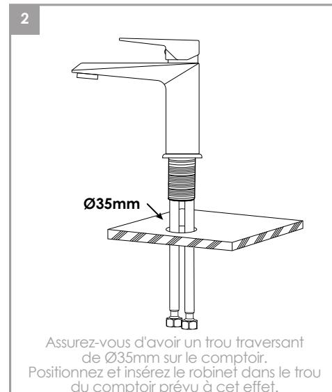
Assurez-vous d'avoir un trou traversant de Ø35mm sur le comptoir. Positionnez et insérez le robinet dans le trou du comptoir prévu à cet effet.
