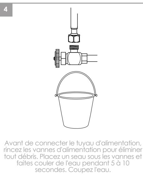
Avant de connecter le tuyau d'alimentation, rincez les vannes d'alimentation pour éliminer tout débris. Placez un seau sous les vannes et faites couler de l'eau pendant 5 à 10 secondes. Coupez l'eau.
