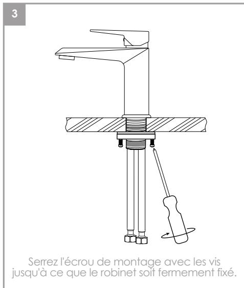
Serrez l'écrou de montage avec les vis jusqu'à ce que le robinet soit fermement fixé.
