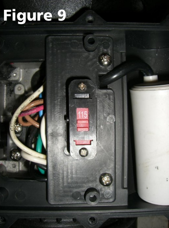
Le commutateur de tension est réglé d'usine à 115 volts.
